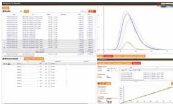
测量过的样品、待分析样品、积分曲线和校准功能分栏显示在同一个界面中
