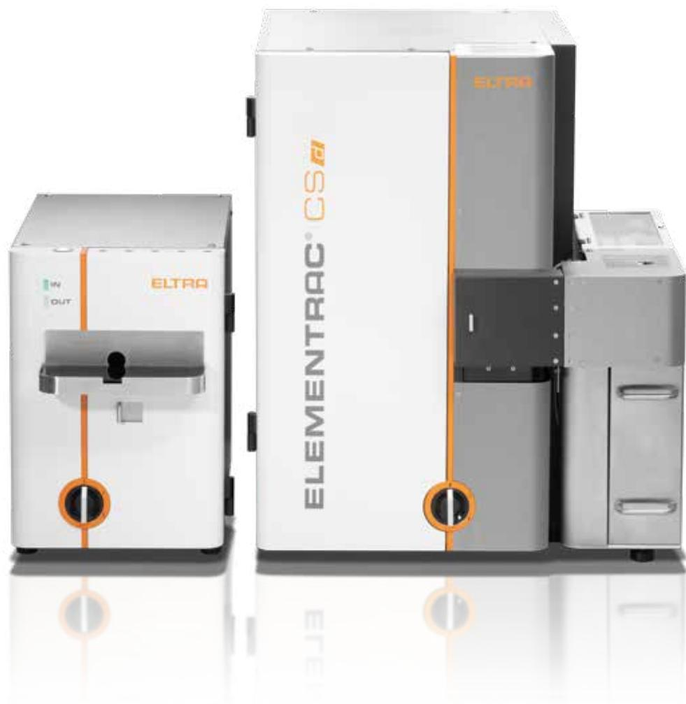
ELEMENTRAC CS-d在ELEMENTRAC CS-i的基础上添加了电阻炉,用以分析有机样品,如木材,塑料,油,土壤的碳/硫含量。
