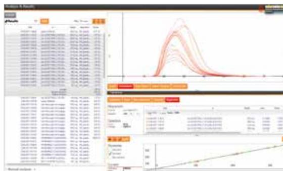
Übersichtliche Anzeige von gemessenen und zu analysierenden Proben, Analysengraphen und Kalibrierfunktionen in einem Fenster
