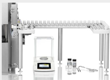
Autoloader con 130 posiciones para crisoles
