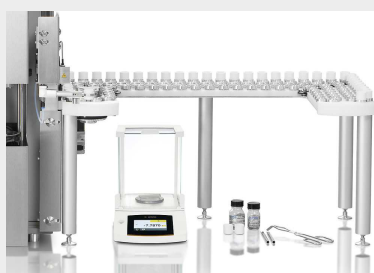
Caricatore automatico con 130 posizioni per crogioli
