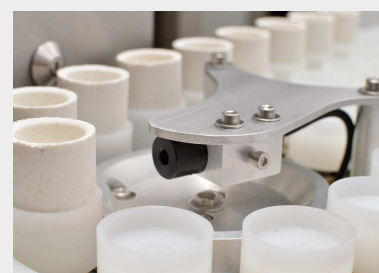
Caricatore automatico con porta crogioli in plastica resistente agli acidi
