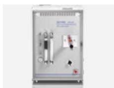
Para el análisis fraccionado de carbono y agua, la serie CW-800 de ELTRA emplea la técnica del análisis por combustión con diferentes temperaturas y gases. Sus analizadores están equipados con un horno de resistencia con tubo de vidrio de sílice que alcanza una temperatura de hasta 1.000°C.
