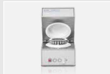
Con el **Thermostep** pueden determinarse diferentes parámetros de la muestra, como el contenido de humedad, materia volátil y cenizas en un solo ciclo de análisis.
