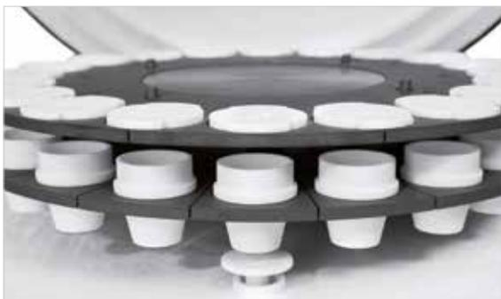
Colocación de las tapas controlada desde la PC / crisoles abiertos
